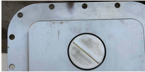
图 4 单机壳体表面金属材料生锈
