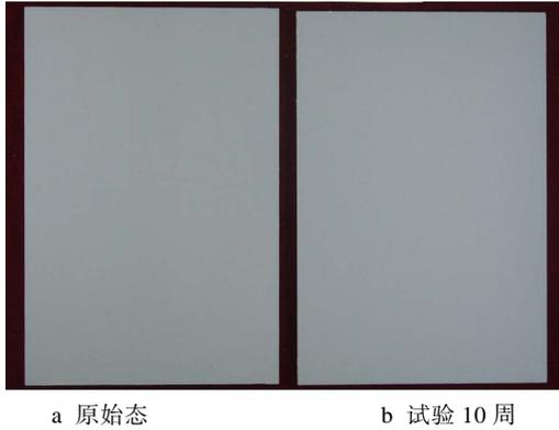
图5 湿热试验10周前后涂层样板形貌对比
