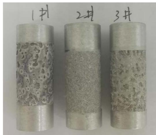
图 1 牺牲阳极电化学容量测试后表面形貌
