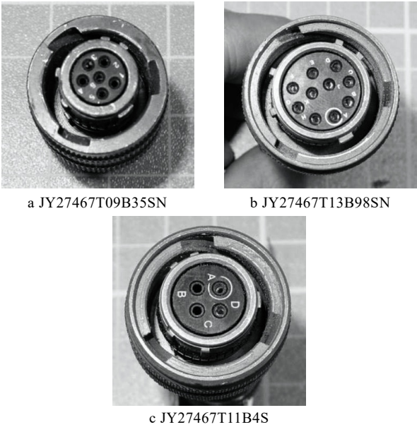
图 2 三种型号电连接器插孔端外观形貌（拆解后）
