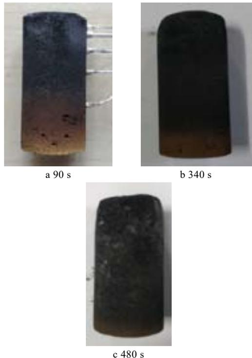
图 4 不同加热时间加热后试件的形貌
