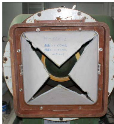
图 2 前盖胀破试验 Fig.2 Burst test of frangible cover
