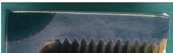
图 11 改进后凸轮轴螺纹孔淬火情况
