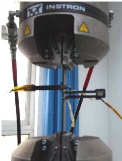
图 2 ±45°循环加载试验 Fig.2 Cyclic test of ±45°
