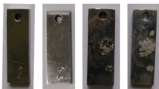
a 含硫、去除腐蚀产物前 b 含硫、去除腐蚀产物后 c 不含硫、去除腐蚀产物前 d 不含硫、去除腐蚀产物后
