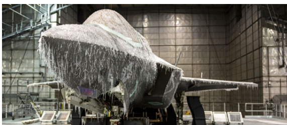
图 1 F35 结冰试验 Fig.1 F35 icing test
