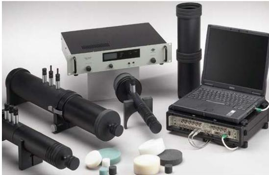
图1 驻波管法测试仪器<sup>[2]</sup>
