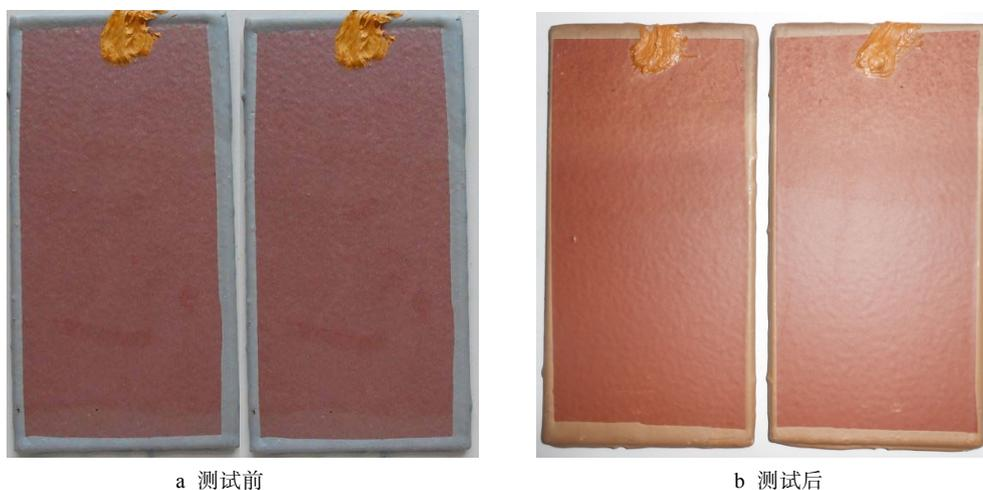
图 2 涂层样板测试前后表面状态
