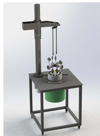
图 1 进行失重法测试所用的高温高压反应釜
