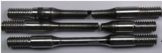
图 4 马氏体不锈钢 13Cr 抗 SSC 实验后试样的宏观形貌 Fig.4 Macro morphology of martensitic stainless steel 13Cr after anti-SSC test
