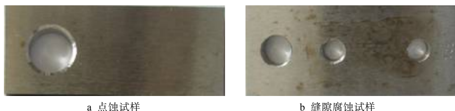
图 2 316L 不锈钢在实海工况浸泡 120 h 后的宏观腐蚀形貌
