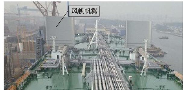
图 2 左右舷横向对称布置的风帆
