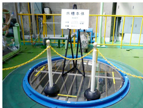
图 1 日本 JAMSTEC 高压舱水槽本体 Fig.1 JAMSTEC deep-sea high pressure simulator in Japan
