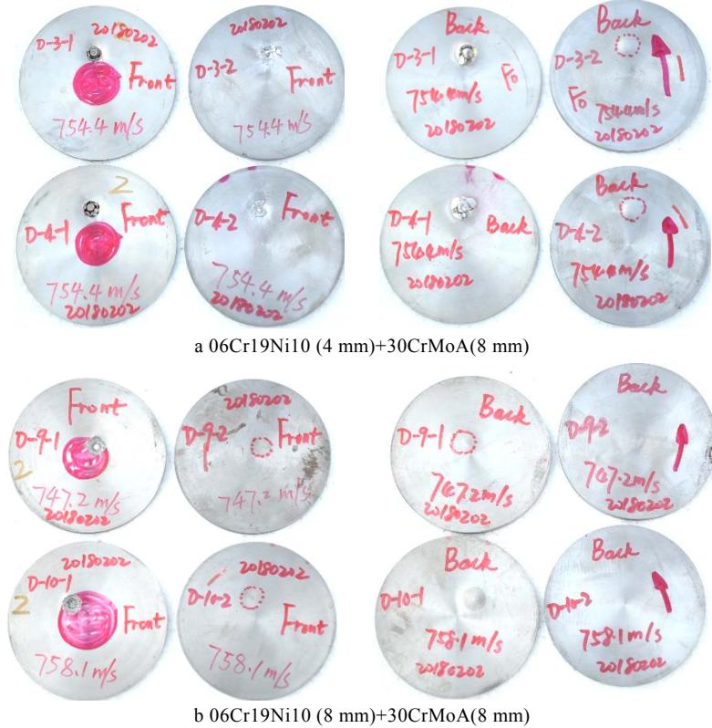
图 12 双层钢板侵彻后形貌对比
