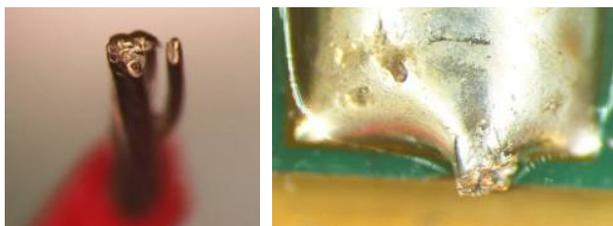
图2 故障导线断裂面及焊点
