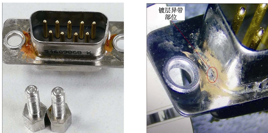
图 4 电连接器拆卸后外壳及镀层腐蚀部位
