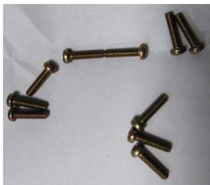
图 9 镀锌螺钉 8 h 盐雾试验后外观
