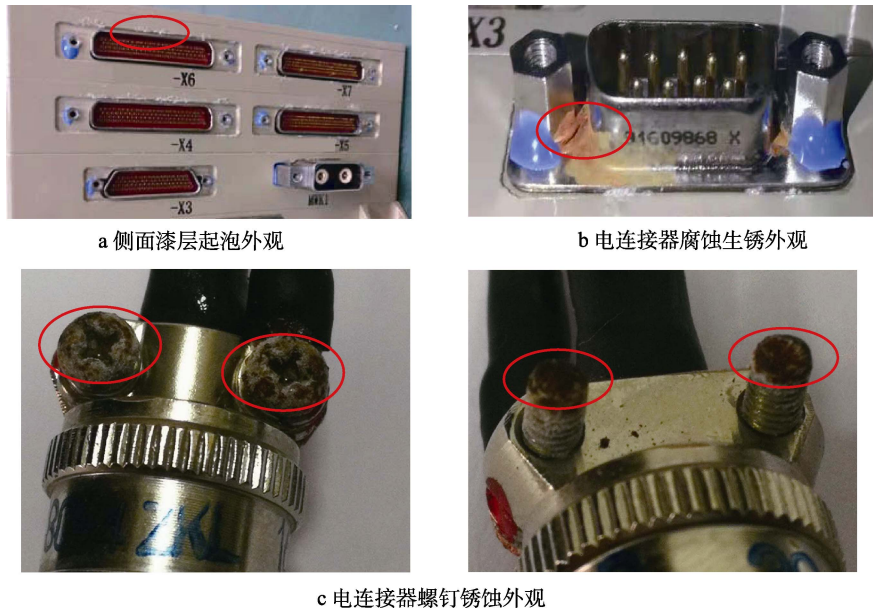
图 1 弹上设备湿热试验后典型外观不合格现象
