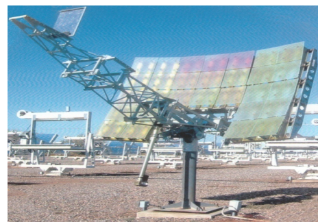
图 2 大型跟踪太阳发射聚能试验设备
