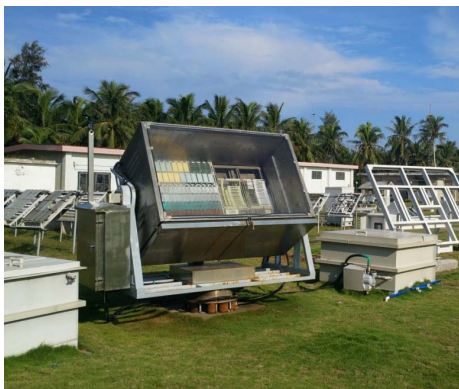
图 3 大气环境综合自然加速试验设备
