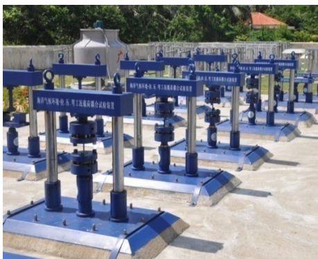
图 4 气候环境-工况耦合试验设备
