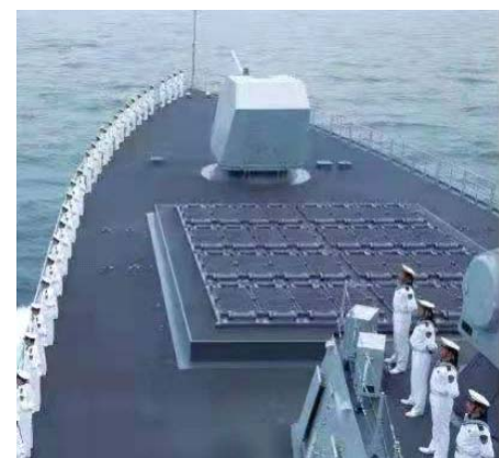
图 7 发射模块的舱口盖单元 2 Fig.7 The hatchcover unit of launch module 2
