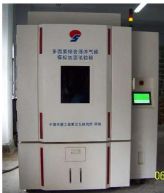
图 5 多因素综合热带海洋气候模拟加速试验箱
