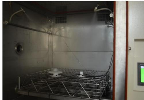
图 7 全辐射和紫外辐射传感器的安装
