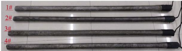
图 4 高硅铬铁棒腐蚀试验后的表面形貌
