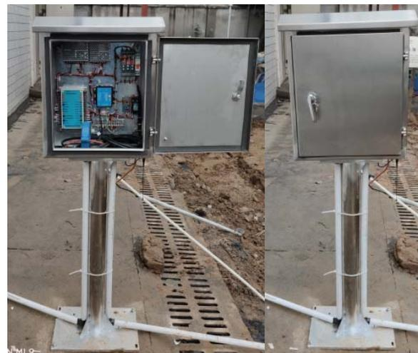
图 6 高硅铬铁腐蚀监测仪安装现场
