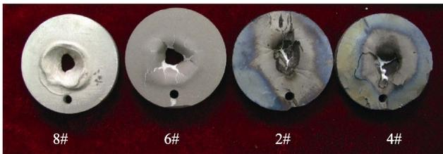
图9 氧-乙炔烧蚀试验后的试样
