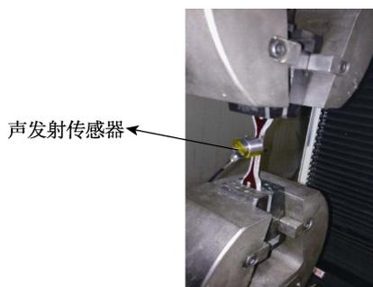
图 6 声发射监测拉伸破坏
