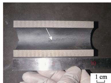
图 2 服役态高温过热器管内壁氧化皮表面形貌
