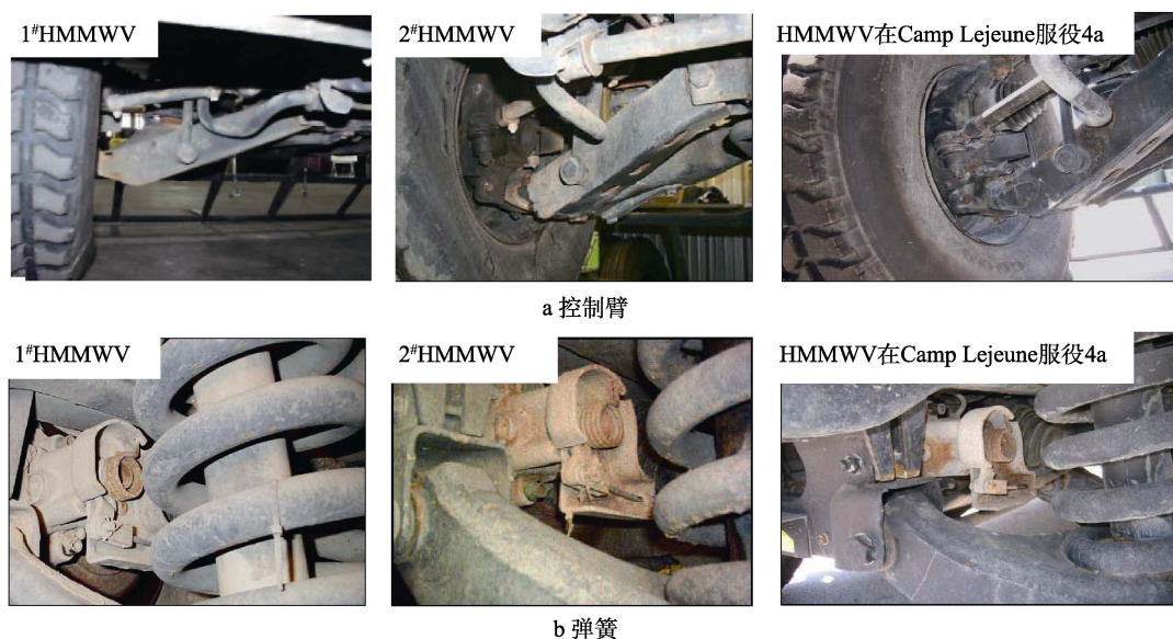
图 4 美国海军陆战队 HMMWV 控制臂和停车制动弹簧暴露 4 a 后的比较 [21-22]
