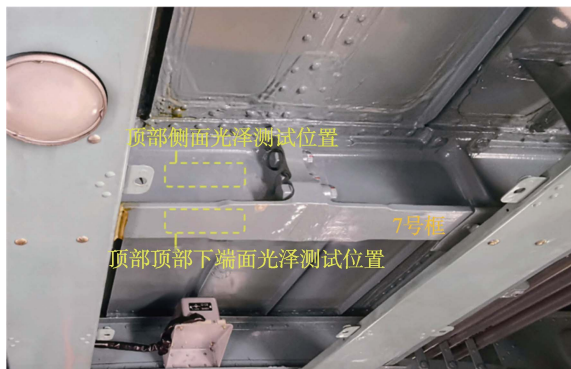
图6 7号框顶部防护涂层的光泽测试照片
