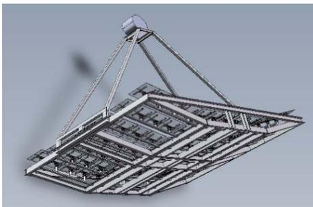
图 6 反射部装与样品试验组件三维结构
