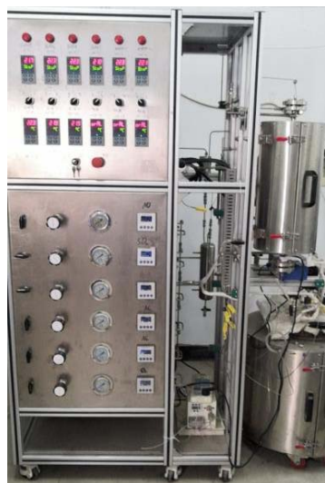
图1 活性炭纤维吸附 \text{SO}_2 、 \text{NO}_2 、 \text{NO} 试验装置 Fig.1 Experimental device of activated carbon fiber adsorbing \text{SO}_2 , \text{NO}_2 , and \text{NO}
