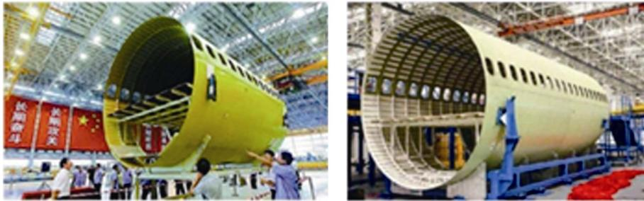
图 1 C919 客机机身部分加筋结构
