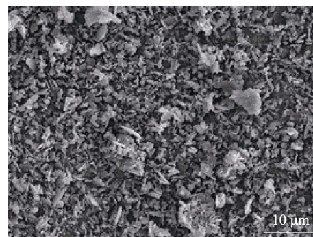
图 1 预处理后微米 B 粉的 SEM 形貌
