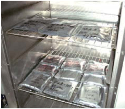
图 2 界面试件高温加速老化试验放置
