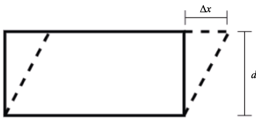
图 3 黏接界面整体剪切变形
