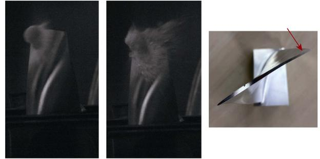
图 5 静止叶片冰撞击试验
