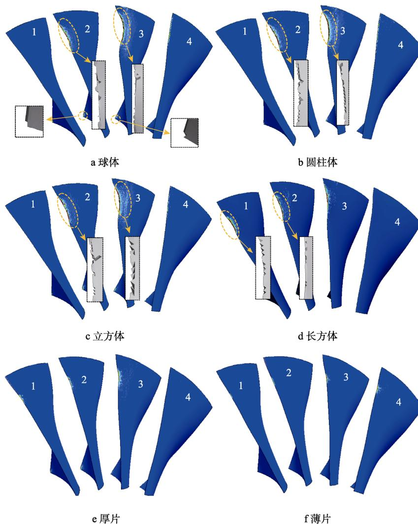
图 11 叶片受不同形状脱落冰撞击的塑性变形
