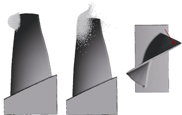
图 6 静止叶片冰撞击数值模拟
