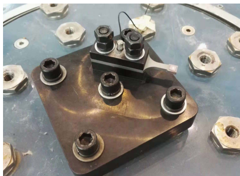
图 5 材料振动弯曲高周疲劳试验现场 Fig.5 Photo of material vibration bending high cycle fatigue test
