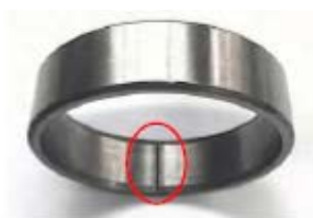
图 13 外圈轴承故障
