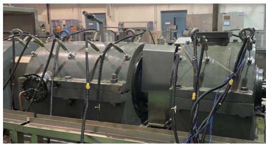
图 6 航空轴承故障模拟试验台 Fig.6 Test bench of aviation bearing fault simulation
