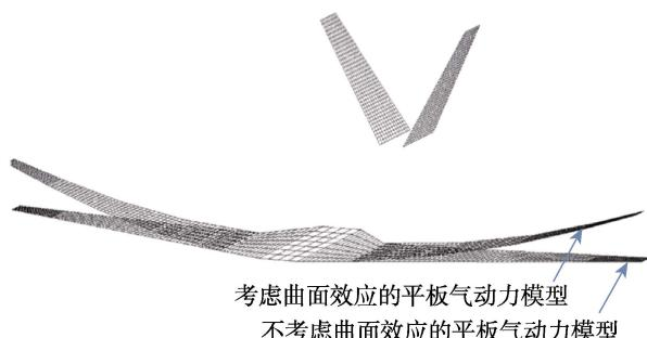
图 7 2 种气动力模型
