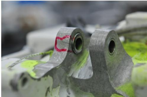
图 2 机载液压驱动装置连接耳片裂纹
