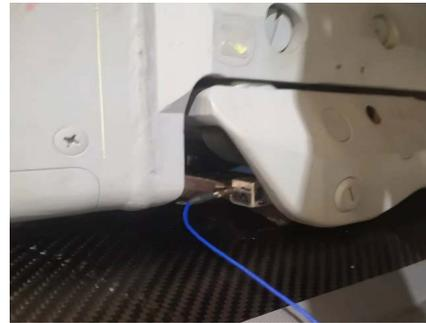
图8 节点位置加速度响应(试验测点)
