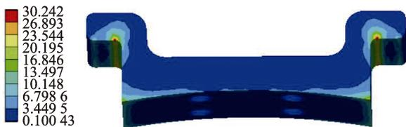
图5 挂飞功能振动下滑块  $1\sigma$  等效应力
