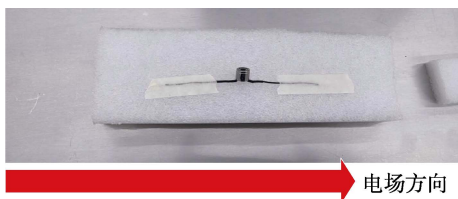
图 7 桥丝式电火工品电磁试验配置状态
