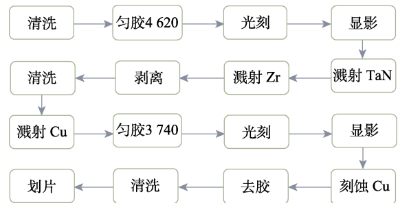
图 2 薄膜换能元工艺流程
