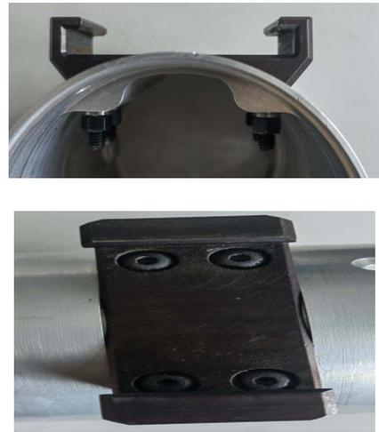
图 18 螺栓+螺母连接结构
