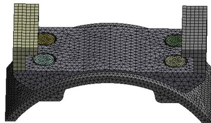
图 6 导弹结构整体有限元模型
