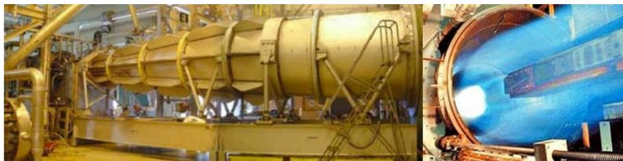
图 8 高温结构风洞<sup>[71]</sup>
