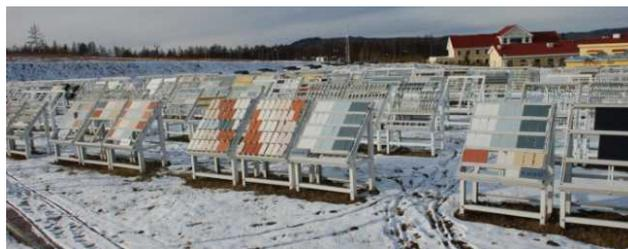
图 6 漠河低温环境适应性试验
