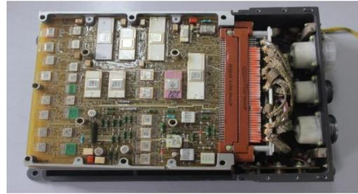
图 1 某型电子调节器内部结构
