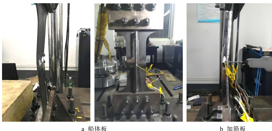
图 13 含裂纹船体板和加筋板试验工装 [82]
