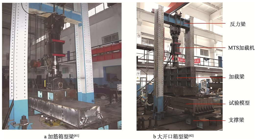
图8 箱型梁模型试验工装
