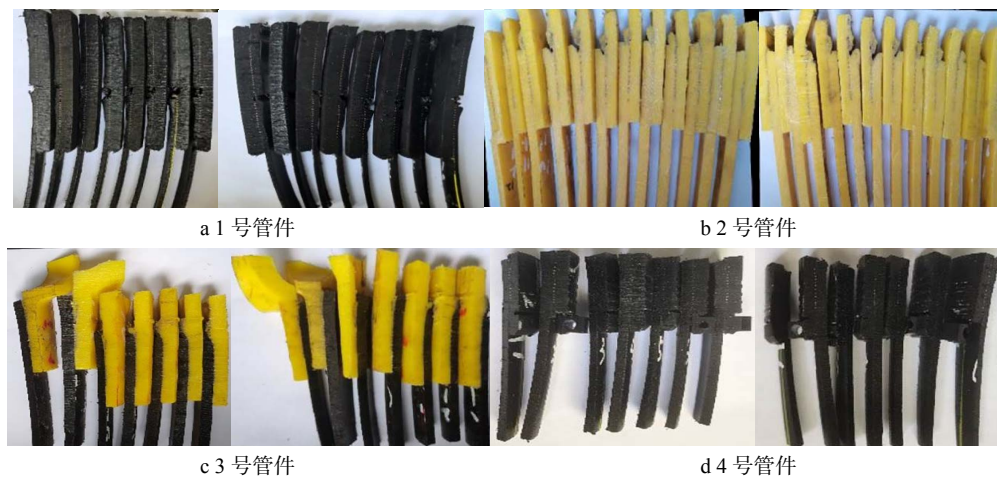
图 4 电熔焊接管件切割截面宏观照片
