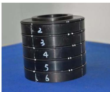
图2 橡胶密封圈压缩工装
