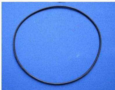
图1 橡胶密封圈样品
